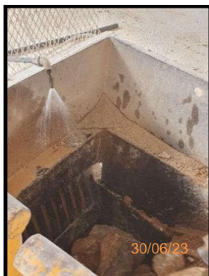
รูปที่ 2-17 ระบบสเปรย์น้ำที่จุดกำเนิดฝุ่น
